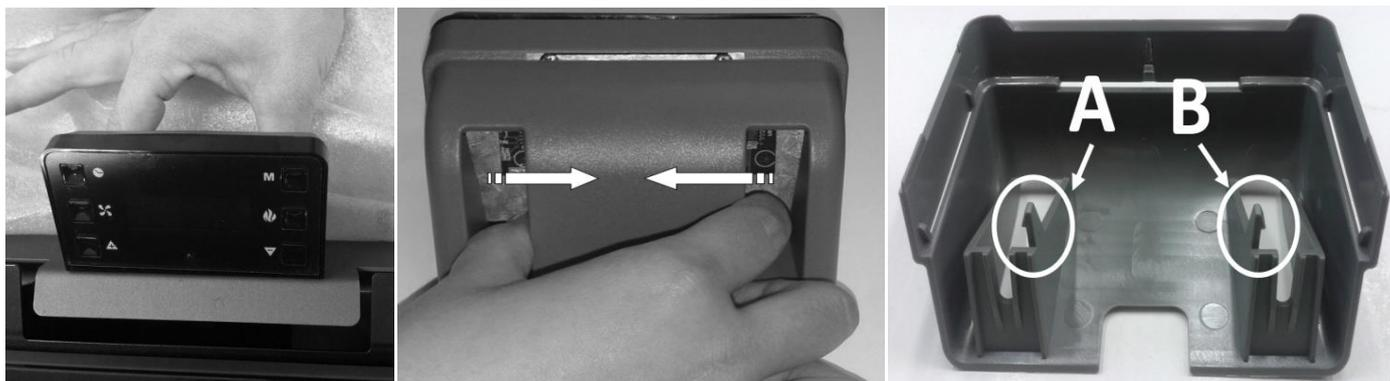
Tirare il guscio verso l'esterno e procedere alla sostituzione della batteria. La batteria scarica, quando rimossa, deve essere smaltita in modo sicuro rispettando la normativa vigente in materia.
